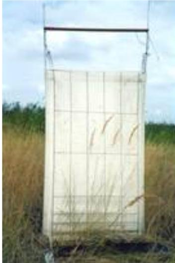
Abb. 4. Leinwand zur Messung von Vegetationsstrukturparametern.
